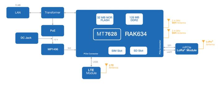
Figure 3: RAK7268V2 WisGate Edge Lite 2 interfaces
